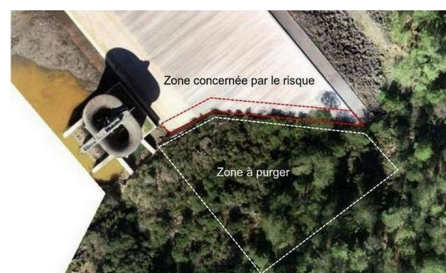
Figure n°7 : zone de purge
